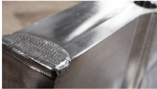
Reparación de la junta de obturación desgastada de un inserto de molde de bronce Ampco
