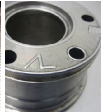
Se efectuó la soldadura de un borde roto en el lado de expulsión de una herramienta moldeada por inyección
