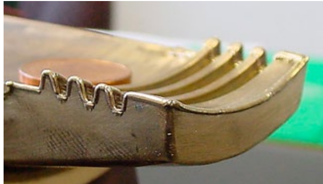
Reparación de la junta de obturación desgastada de un inserto de molde de bronce Ampco
