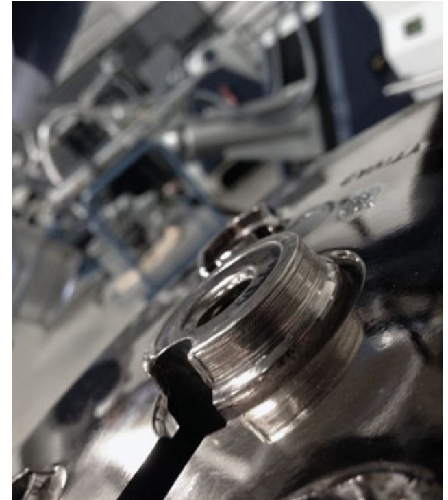
Las piezas de engranajes (en este caso una rueda dentada) son montadas y soldadas con un calentamiento muy reducido.
