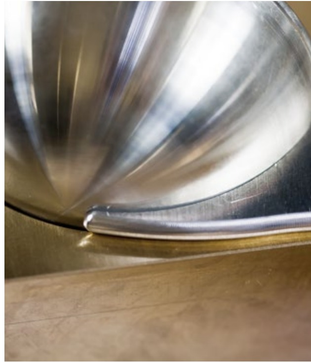
La soldadura láser también se emplea en la fabricación de piezas en serie (en este caso un anemómetro)
