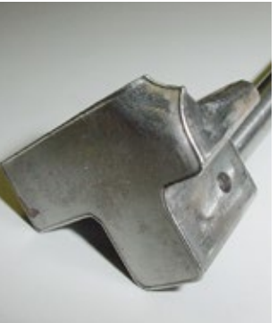
Se efectuó la soldadura de un borde roto en el lado de expulsión de una herramienta moldeada por inyección
